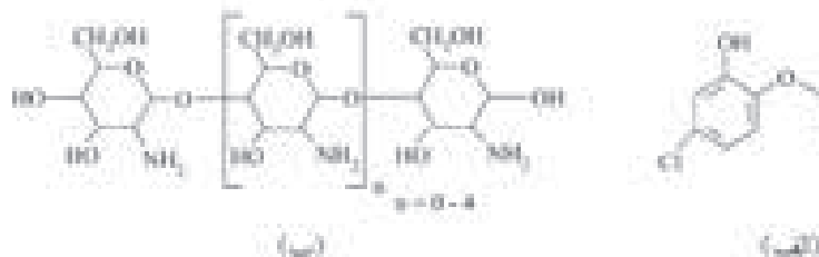
شکل ۱- ساختار مولکولی چیتوسان (الف) و تری کلوسان (ب) دو ماده‌ی ضدباکتری مورد استفاده در صنعت نساجی
